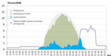
L'impianto fotovoltaico è connesso alle utenze del condominio. L'energia prelevata (linea viola) che coincide con la produzione dell'impianto (area grigia) è direttamente fornita dallo stesso ed è chiamata autoconsumo (area celeste). Qualsiasi eccesso di energia prodotta (area verde) è immesso nella rete di distribuzione pubblica.
